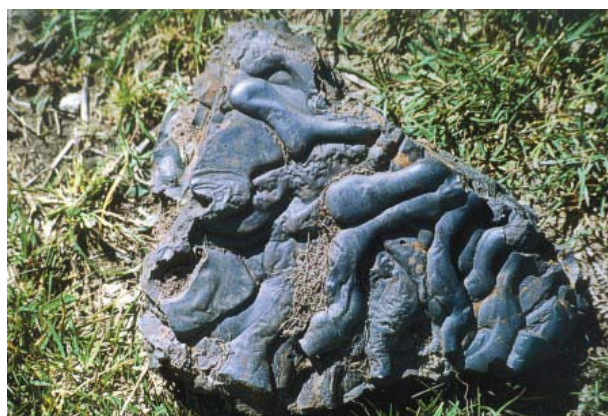
Foto 2. Trozo de escoria globulosa de una haizeola . La aparición de este tipo de escoria en una zona de montaña o en lugares alejados de los cauces de los ríos, delata la antigua existencia de una ferrería de montaña en las inmediaciones.
