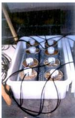
Foto 3. Dispositivo experimental para el estudio de la evaporación de los suelos.
