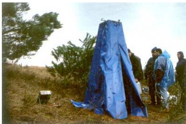
Foto 2: Experimento de simulación de lluvia para el estudio de las características hidrológicas de los suelos.
