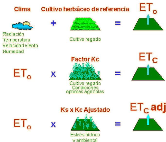
Figura 5. Proceso de obtención de la evapotranspiración (denominada en este caso ET c y ET c ajustada) a través de factores de corrección aplicados a la evapotranspiración de referencia de un cultivo o región (ET o ).
