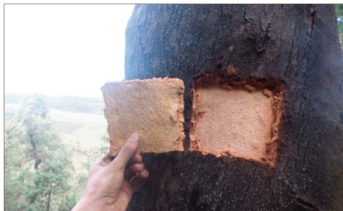
Figura1. Metodología aplicada para la toma de muestras de corcho; a) sondeo con COVELESS; b) extracción de la cala.
