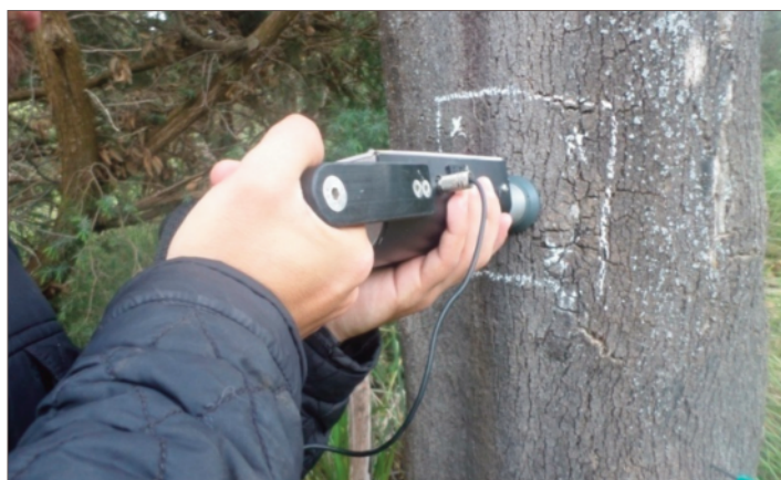
Figura1. Metodología aplicada para la toma de muestras de corcho; a) sondeo con COVELESS; b) extracción de la cala.
